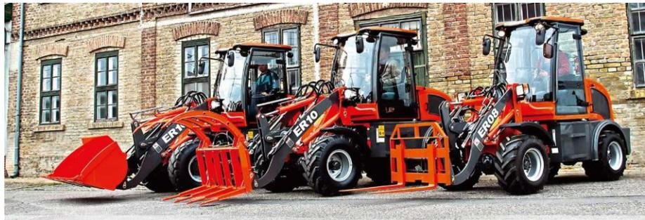
EVERUN имеют комфортную кабину с круговым обзором на 360 градусов. Для удобства работы оператора погрузчики оснащены гидравлической трансмиссией, джойстиком управления, тканевым сидением, обогревателем, автомагнитолой с MP3, камерой заднего вида. Кроме того, для легкого запуска двигателя при низких температурах, погрузчики EVERUN укомплектованы предзапусковым подогревом двигателя и охлаждающей жидкости от сети 220V.
